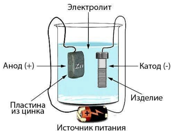
Рис. 1. Схематическое изображение простейшей гальванической ванны цинкования
