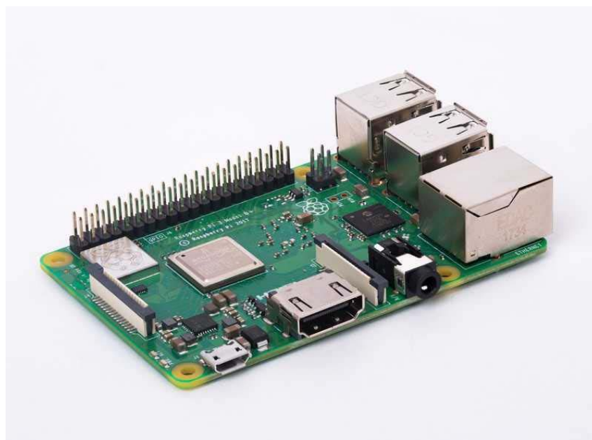
Рис. 1. Внешний вид Raspberry Pi 3B+
