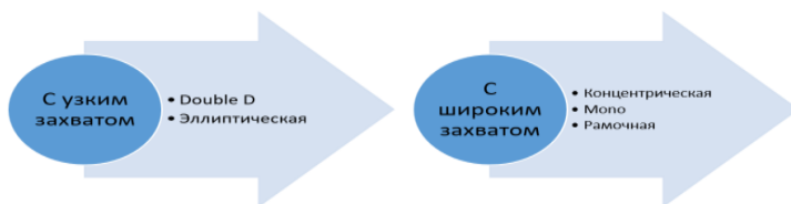
Рис. 3. Особенности конструкции и функционирования поисковых катушек
