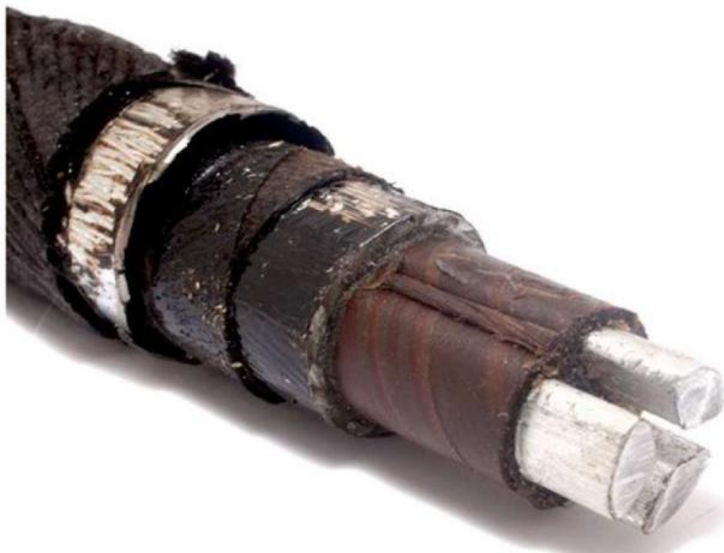
Рис. 1.16. Внешний вид кабеля с бумажной с битумной пропиткой
