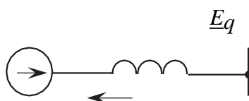
Рис. 3.15 Схема замещения синхронного компенсатора
