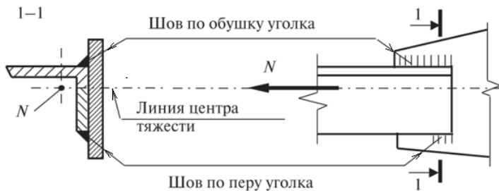
Рис. 10. Крепление уголка к фасонке угловыми сварными швами
