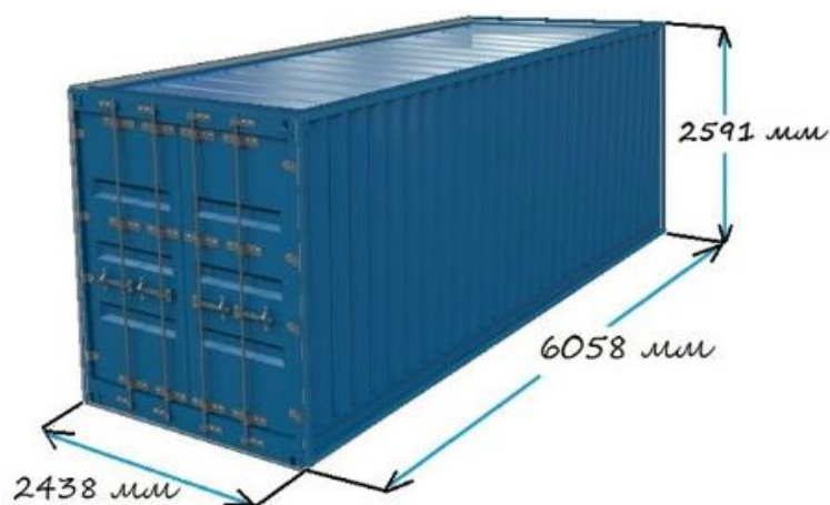
Рис. А1. Внешний вид и габаритные параметры 20-футового контейнера
