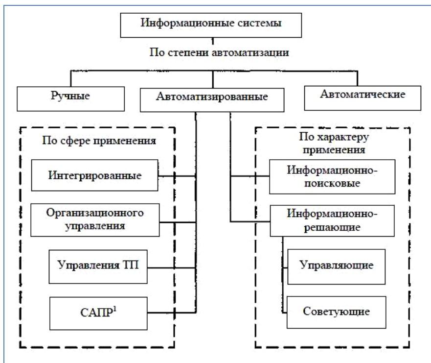
Рис 7.2. Классификация информационных систем по степени автоматизации (Информатика / под ред. Н. В. Макаровой. – М., 1998. – С. 85)
