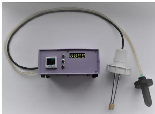
**Рис. Б4. Устройство для контроля периодов пульсаций доильных аппаратов и измерения давления сосковой резины на конец соска**
