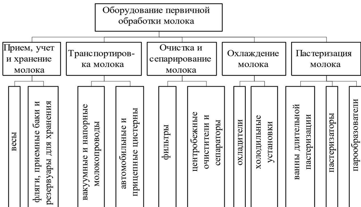
**Рис. 152. Классификация оборудования для первичной обработки молока**
