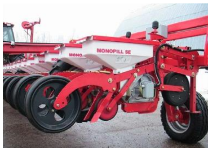
Рис. 4.27. Вид (сбоку) на высевающую секцию сеялки пунктирного высева «MONOPILL SE» с электроприводом высевающего диска
