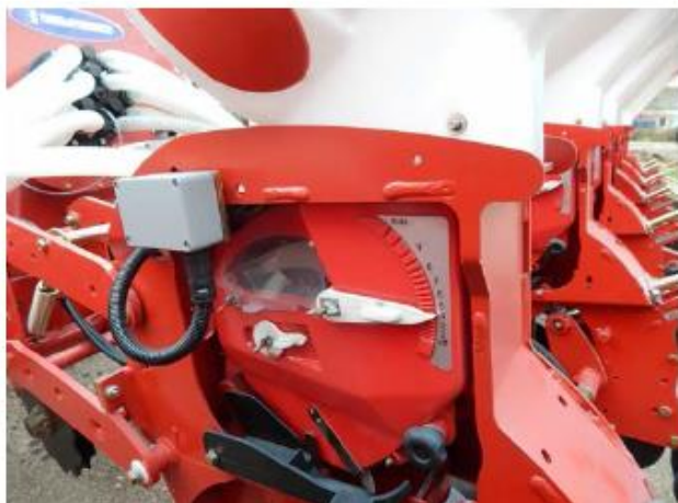
Рис. 4.39. Вид на электродвигатель привода высеваящего диска посевной секции сеялки
