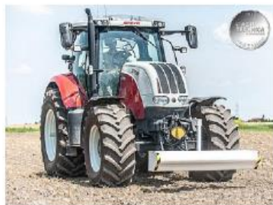
Рис. 4.10. Общий вид на бесконтактную систему измерения свойств почвы Geoprospectors KG Topsoil Mapper
