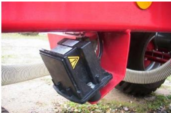
Рис. 4.37. Элемент (радарного типа) регистрации текущей скорости движения посевного комплекса
