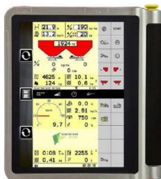
Рис. 4.23. Меню isobus терминала фирмы Kverneland, подключенного к разбрасывателю
