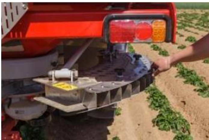
Рис. 4.25. Система управления шириной внесения удобрений на краю поля
