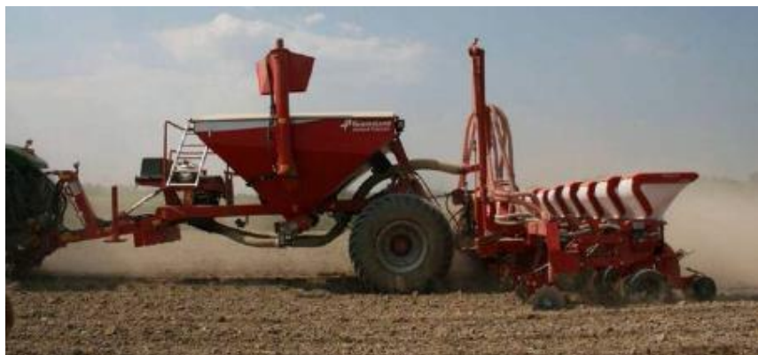
Рис. 4.36. Общий вид бункерной тележкой «FLEXCARD» с сеялкой точного высева для кукурузы «Optima HD» при выполнении технологической операции
