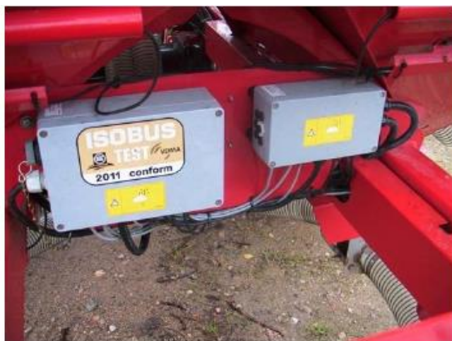
Рис. 4.40. Вид на электронный блок управления (шину ISABUS), установленный на раме комплекса
