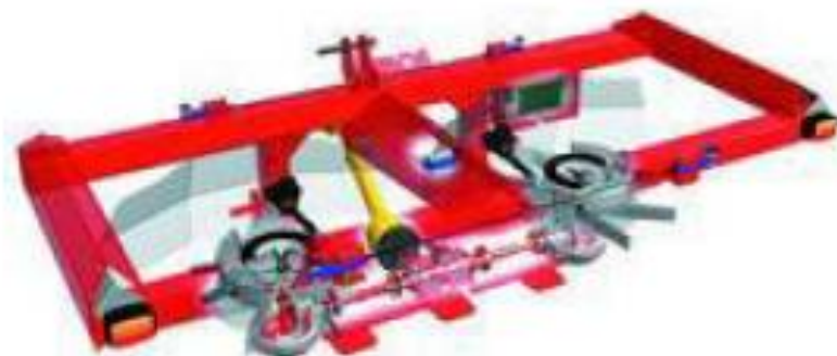
Рис. 4.24. Система взвешивания с 5 датчиками массы
