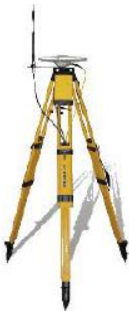
Рис. 4.45. Базовая станция корректировки сигнала
