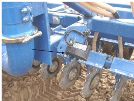
Рис. 4.34. Элемент (радарного типа) регистрации текущей скорости движения сеялки
