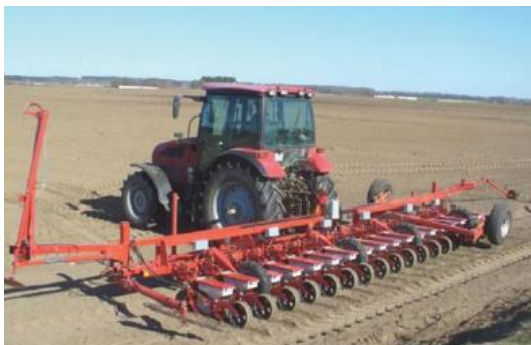
Рис. 4.26. Вид на сеялку «MONOPILL SE» в агрегате с трактором при выполнении технологического процесса посева свеклы
