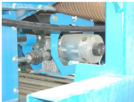
Рис. 4.32. Электродвигатель привода высевяющих аппаратов регулировки нормы высева
