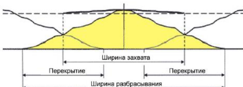
Рис. 4.42. Соотношение между шириной захвата и шириной разбрасывания центробежными разбрасывателями
