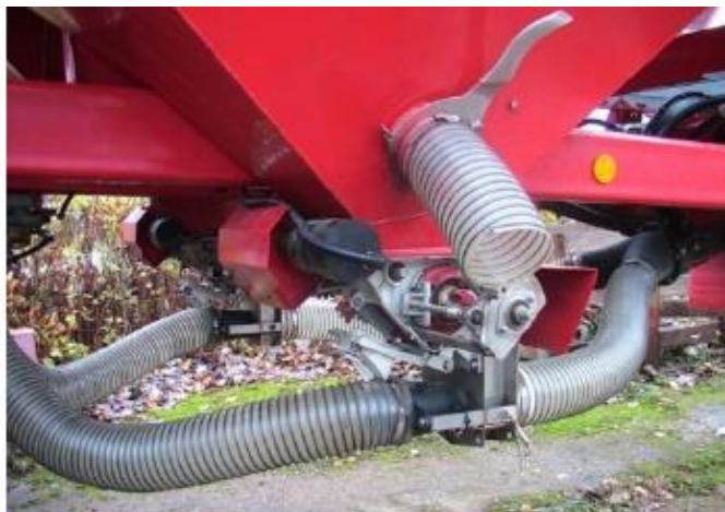
Рис. 4.38. Вид на электродвигатель привода высевальных аппаратов регулировки нормы внесения удобрений
