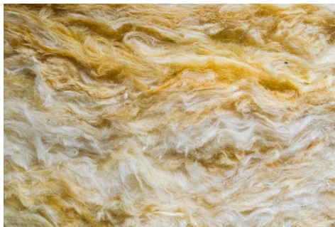
Рис. 2. Структура минераловатной плиты
