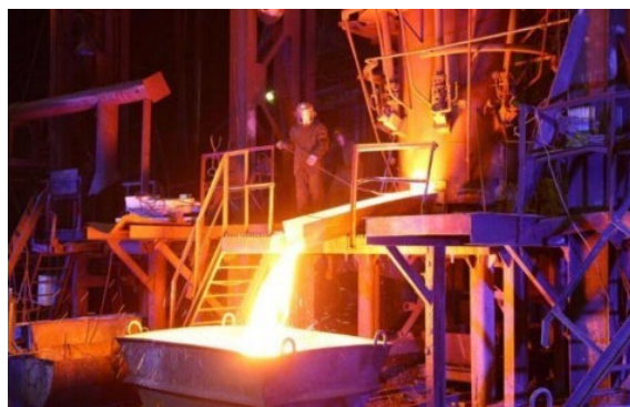
Рис. 12. Охлаждение расплава после вагранки
