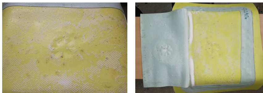
Рис. 2.12. Распределение ремонтного состава в картах с профилированной верхней мембраной LOGICBASE V-ST
