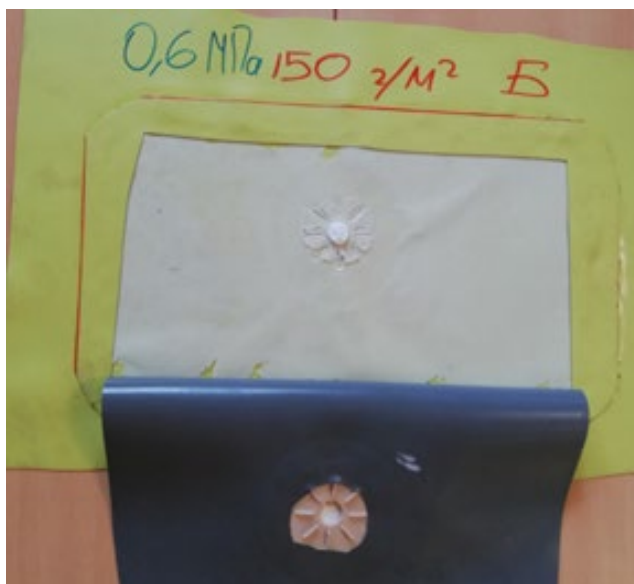
Рис. 2.14. Распределение ремонтного состава в картах с геотекстилем 150 г/м 2 , находящихся под давлением пресса 0,6 МПа
