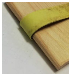
Рис. 3.24. Испытание на гибкость на бруссе радиусом 5 мм
