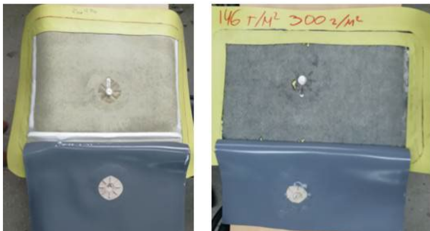
Рис. 2.13. Распределение ремонтного состава в картах с геотекстилем 300 и 500 г/м 2 , находящихся под давлением пресса 1,46 МПа
