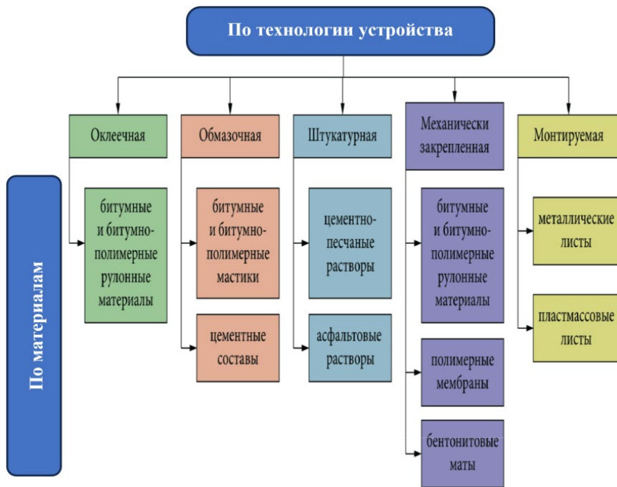
Рис. 1.9. Классификация гидроизоляционных покрытий [9]
