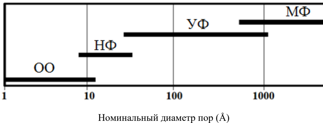
Рис. 2.4. Диапазон номинальных размеров пор мембраны
