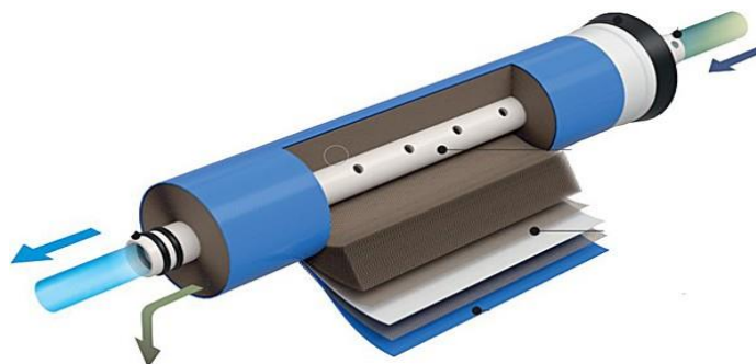
Рис. 3.2. Конструкция мембран модуля ультрафильтрации
