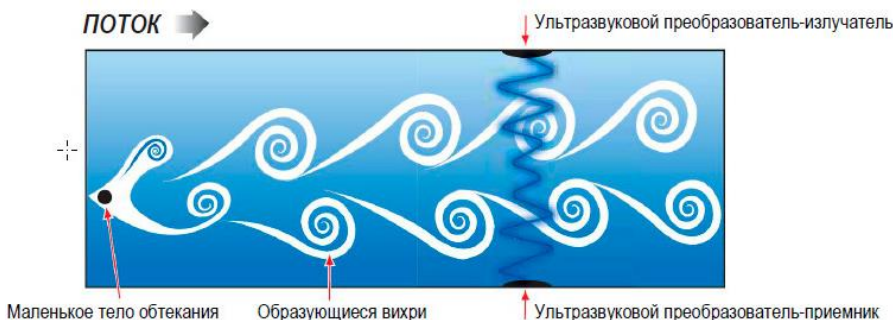
Рис. 5.5. Принцип работы вихревого расходомера
