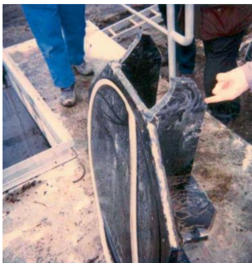
Рис. 6.5. Обратный клапан DN 800 мм после скачка давления в напорной трубе
