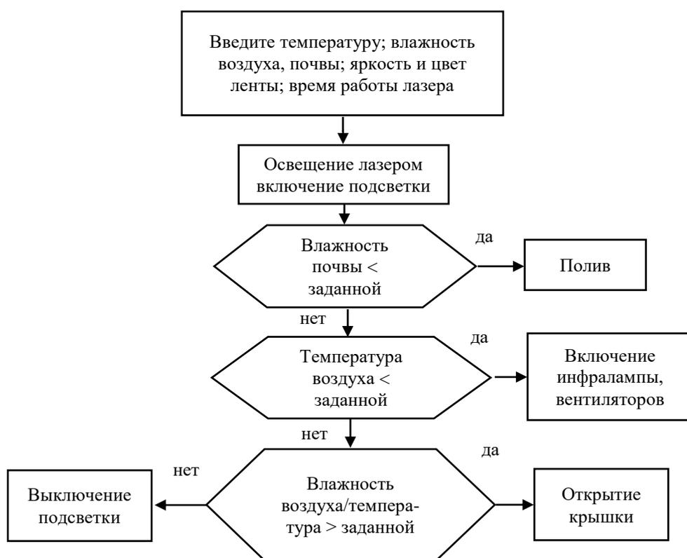
Рис. 2. Блок-схема управления теплицей
