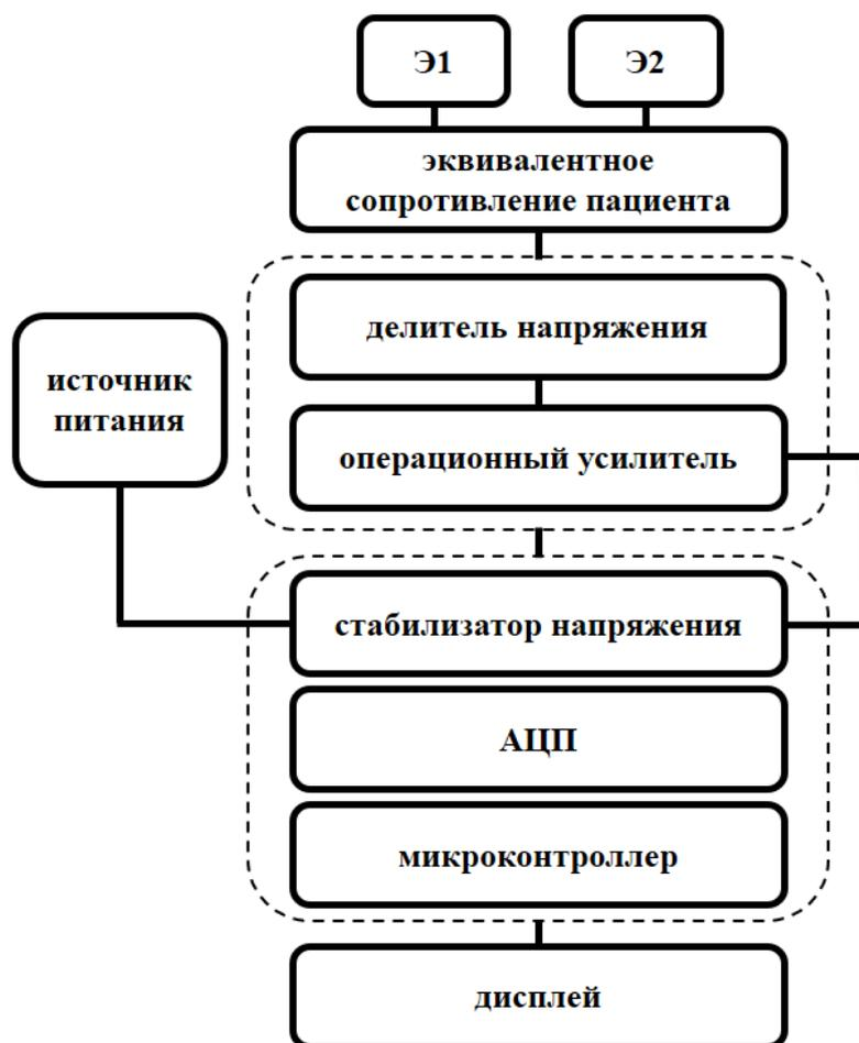
Рис. 1. Структурная схема устройства для проверки энергии импульса дефибриллятора
