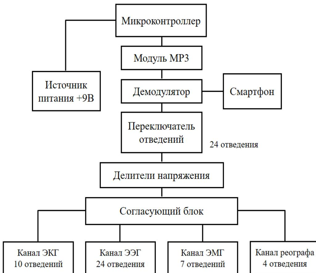
**Рис. 1. Структурная схема имитатора сигналов для проверки работоспособности приборов функциональной диагностики**
