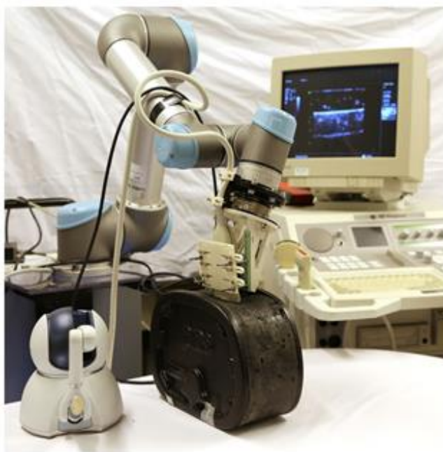
Рис. 1.24. Применение коллаборативного манипулятора UR5 для ультразвуковых исследований
