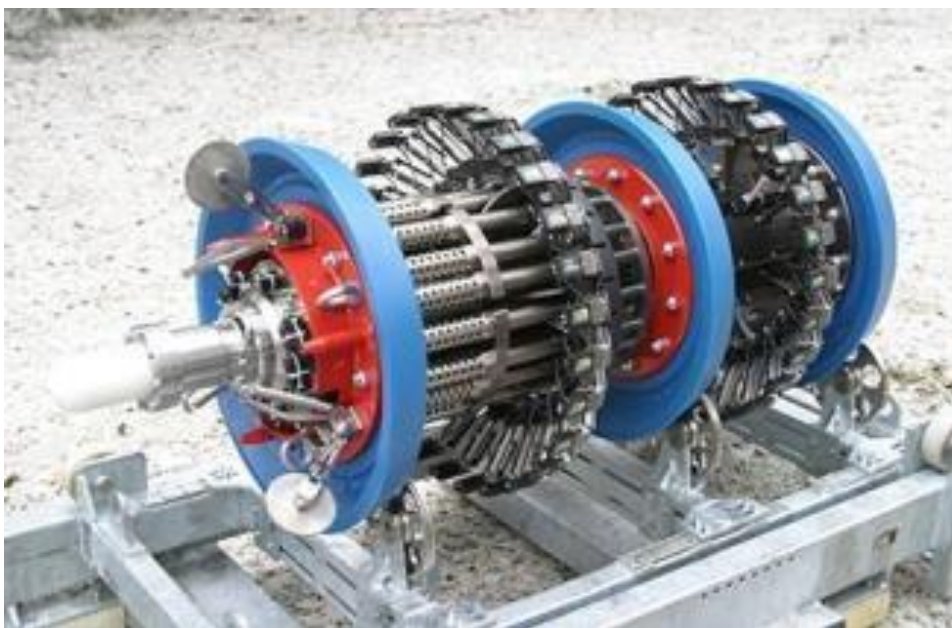
Рис 2.13. Вихретоковый датчик-скребок фирмы Rosen
