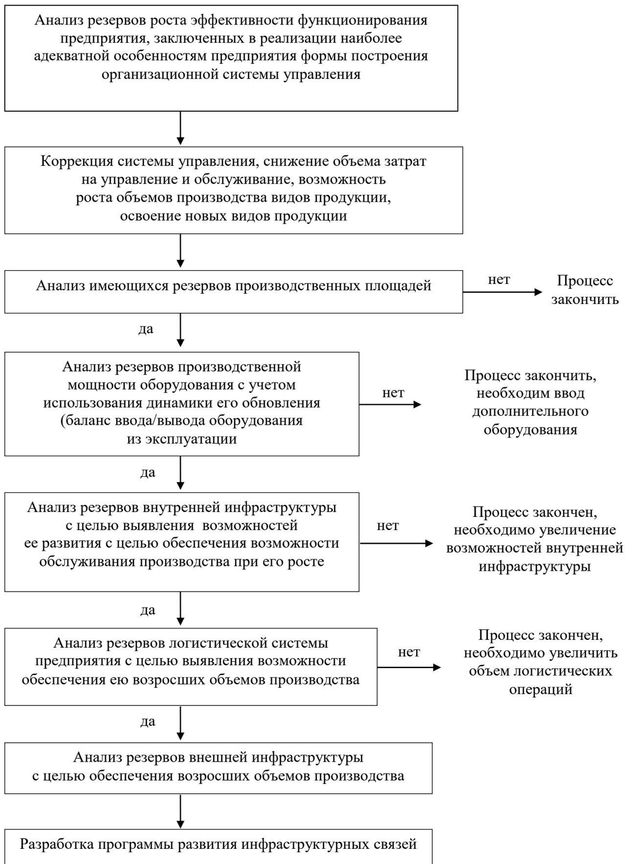
**Рис. 14.** Алгоритм технологии общей идентификации резервов для роста технологической конкурентоспособности промышленного предприятия
