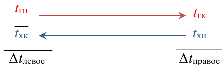
Рис. 6.2. Схема противоточного движения теплоносителей для расчета средней движущей силы
