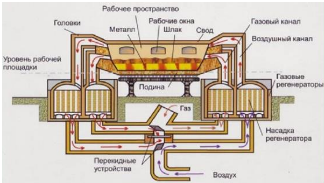
Рис. 3.4. Схема сталеплавильной печи с регенератором
