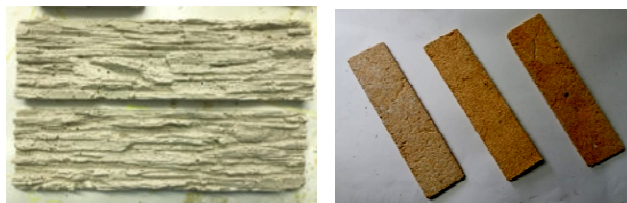
Рис. 1. Декоративные плитки: 270×85×15 мм (а), 220×55×5 мм (б)
