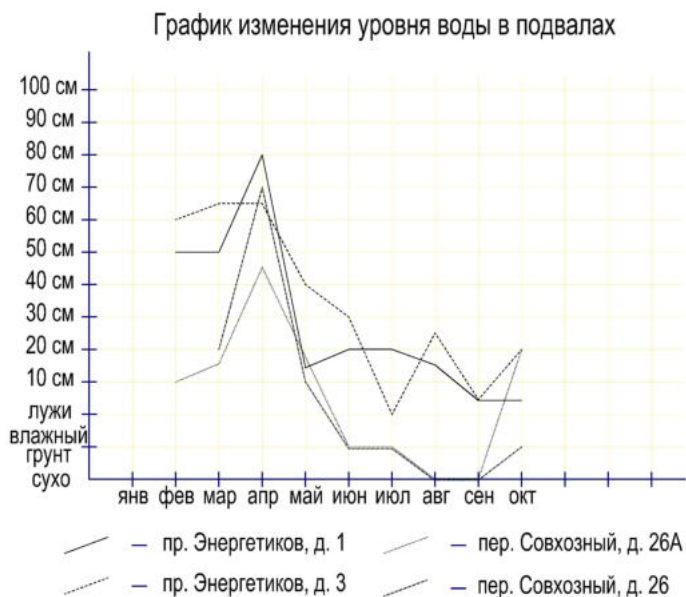
Рис. 3. График изменения уровня воды в подвальных помещениях
