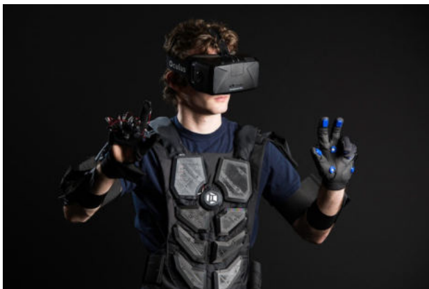
Рис. 2. Костюм захвата движений для VR-приложений
