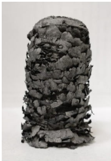
Рис. 1. Внешний вид графенсодержащего сорбента на основе рапса
