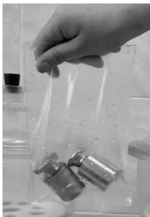
Рис. 2. Анализ съедобного биоразлагаемого покрытия на прочность и эластичность
