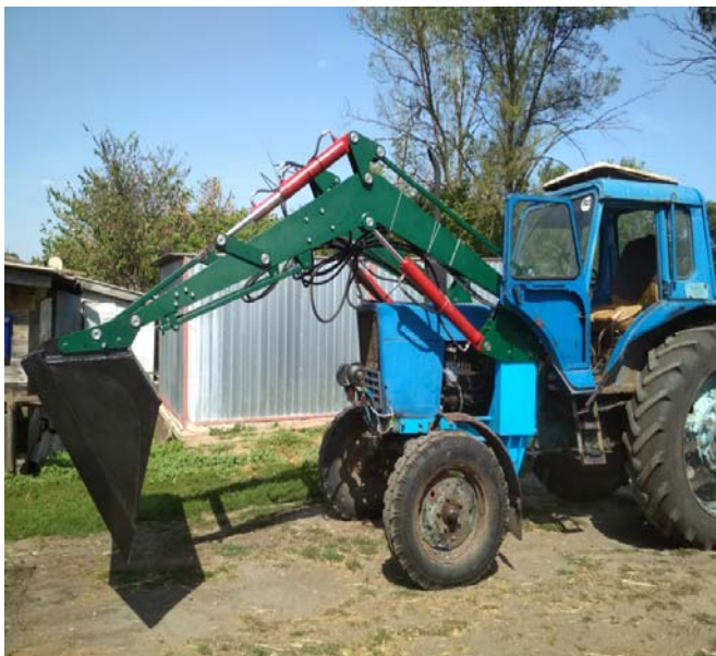
Рис. 3. Фотография фронтального погрузчика, установленного на МТЗ-82
