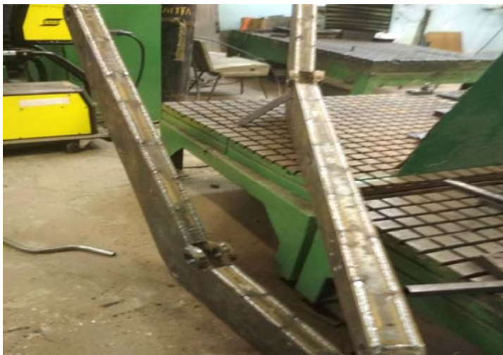
Рис. 2. Фотография стрелы фронтального погрузчика
