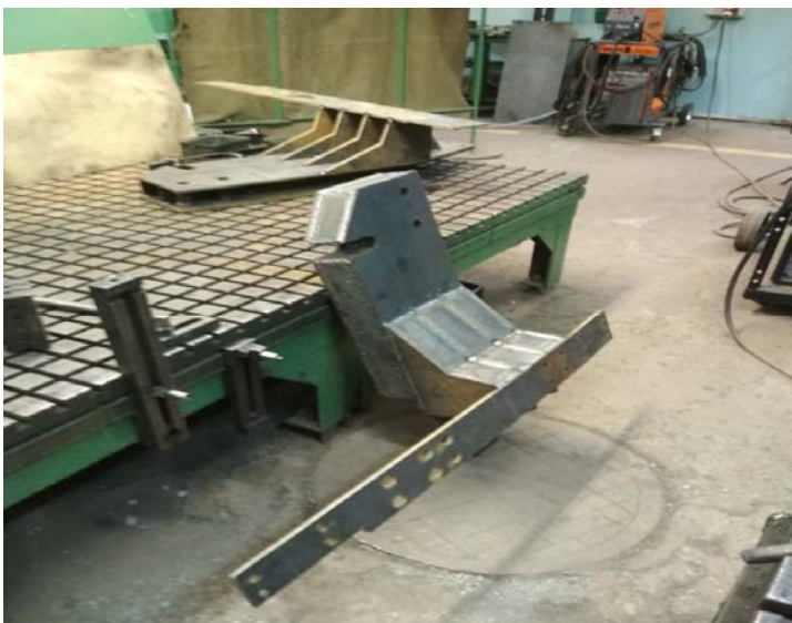
Рис. 1. Фотография кронштейна фронтального погрузчика
