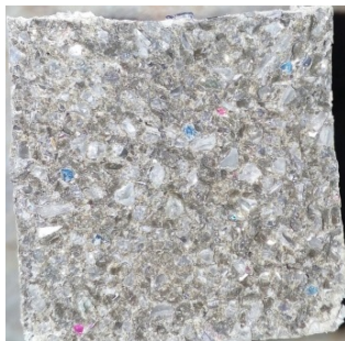
Рис. 1. Структура образца цементного композиционного материала с использованием утилизируемых измельченных оптических дисков
