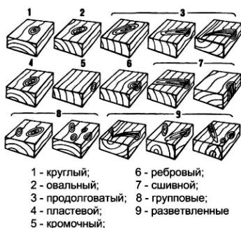
Рис. 1. Виды сучков в зависимости от их месторасположения
