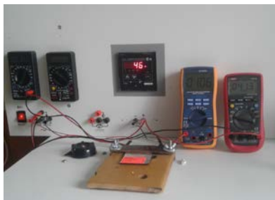
Рис. 1. Саморегулируемый нагреватель на основе наномодифицированного силиконового каучука (а) и стенд для его испытания (б)
