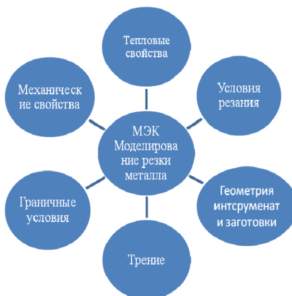
Рис. 2. Входные параметры для моделирования процесса резания
