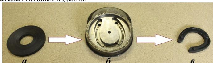
**Рис. 4. Схема изготовления подковы из заготовки СВМПЭ твердофазной объемной штамповкой:**
