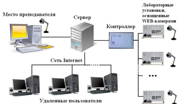
Рис. 1. Структурная схема лабораторного комплекса
