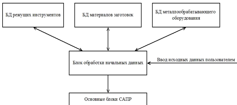
Рис. 1. Структурная схема получения информации из БД
