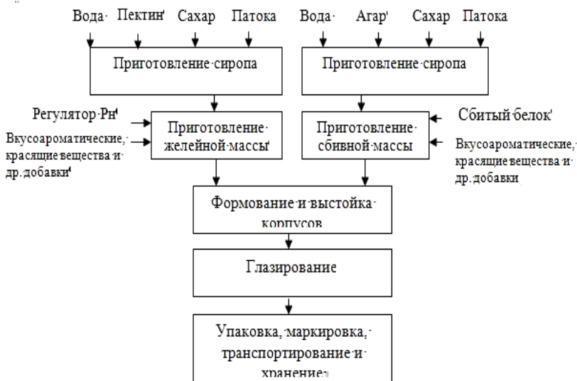
Рис. 1. Структурная схема процесса производства комбинированных желейно-сбивных конфет
