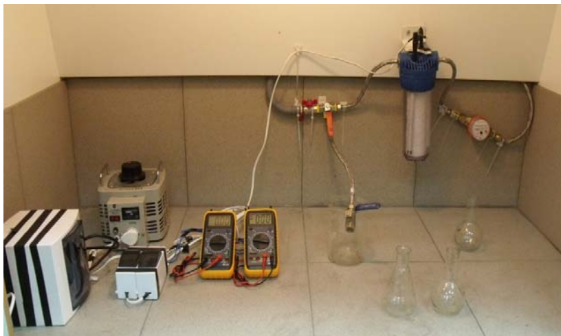
Рис. 1. Экспериментальная установка кондиционирования воды
