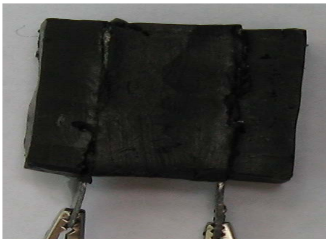
Рис. 3. Внешний вид электрического нагревателя на основе наномодифицированного материала
