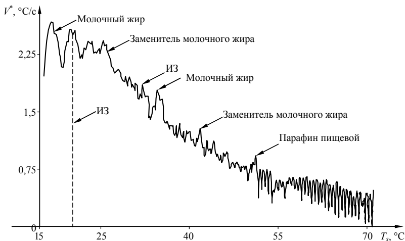
Рис. 3. Зависимость V = f(T) . Объект испытаний – сыр в парафинизированной оболочке
