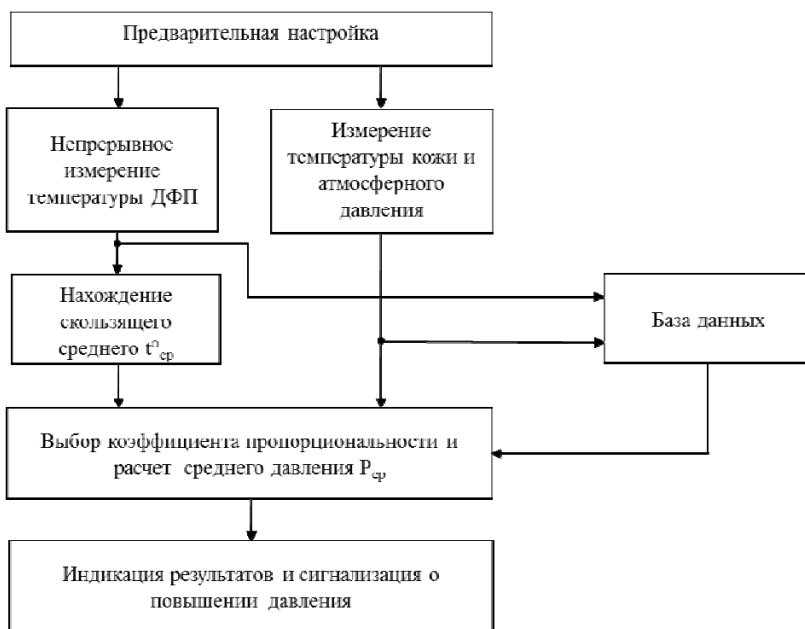
Рис. 2. Блок-схема программной реализации метода определения артериального давления
