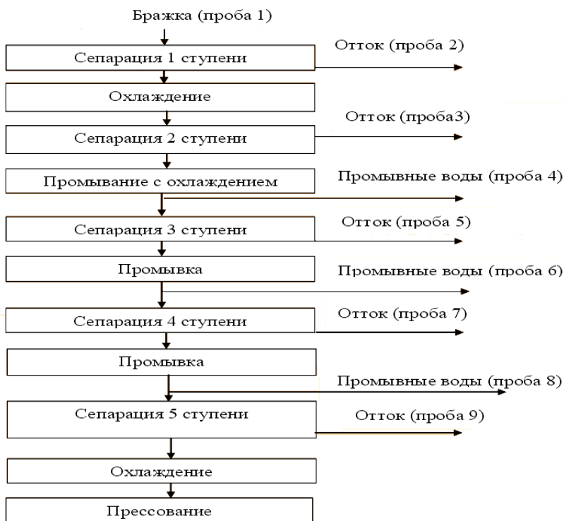
Рис. 1. Схема отбора проб на участке сепарации бражки
