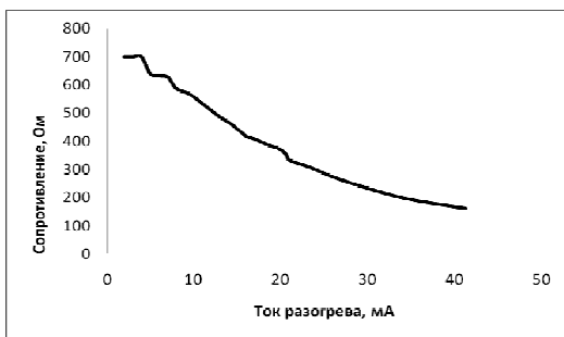
Рис. 2. Характеристика нагрева терморезистора М1К0 прямым подогревом
