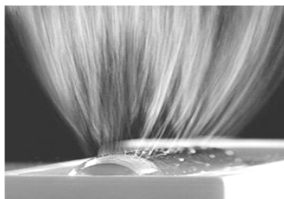
Рис. 3. Нановолокна, полученные методом электроформования
