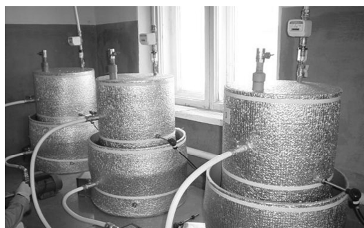
Рис. 1. Лабораторные биореакторы-метантенки объемом 100 литров для изучения процесса получения биогаза (с. Горелое Тамбовской области)
