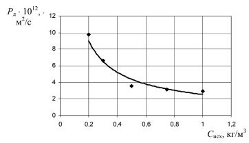
Рис. 2. Зависимость коэффициента диффузионной проницаемости от исходной концентрации соли в растворе
