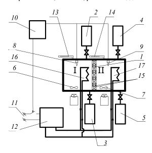
Рис. 1. Схема установки для измерения диффузионной и осмотической проницаемости мембран
