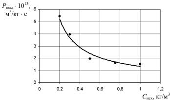
Рис. 3. Зависимость коэффициента осмотической проницаемости от исходной концентрации соли в растворе
