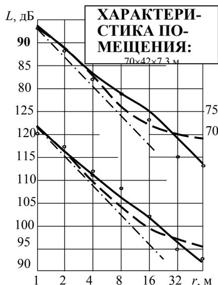
Рис. 2 Экспериментальные и расчетные уровни звукового давления в плоском производственном помещении:
