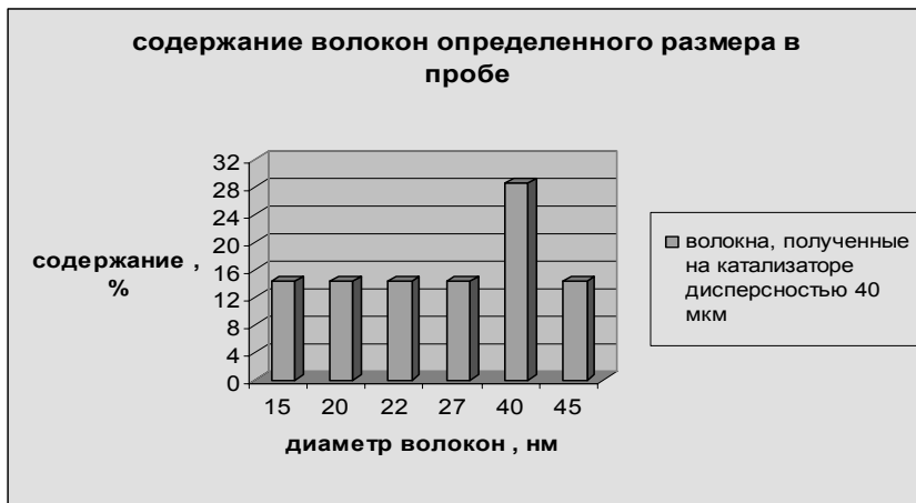
Диаграмма 4. Размер и процентное содержание УНМ, полученного на катализаторе дисперсностью 40 мкм
