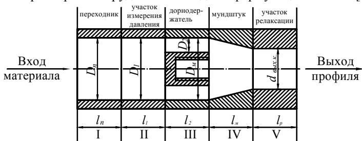
Рис. 1. Компоновка формирующих каналов экструзионной головки: I, II – цилиндрический; III – (три канала произвольной формы), IV - конический; V – цилиндрический
