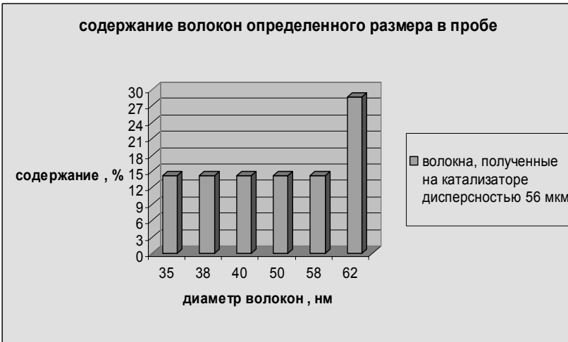
Диаграмма 3. Размер и процентное содержание УНМ, полученного на катализаторе дисперсностью 56 мкм
