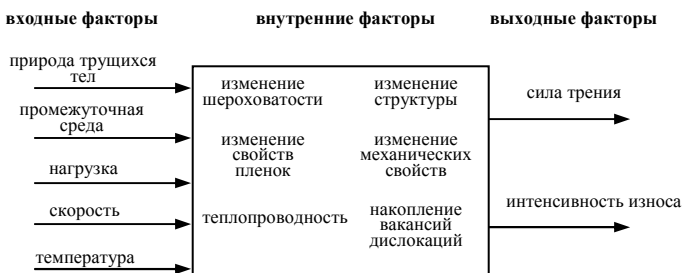
Рис. 1. Схема факторов, влияющих на фрикционное взаимодействие твердых тел
