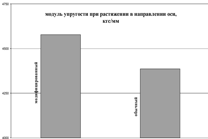
Рис. 3. Модуль упругости при растяжении образца из композита предел прочности при сжатии, кгс/мм
