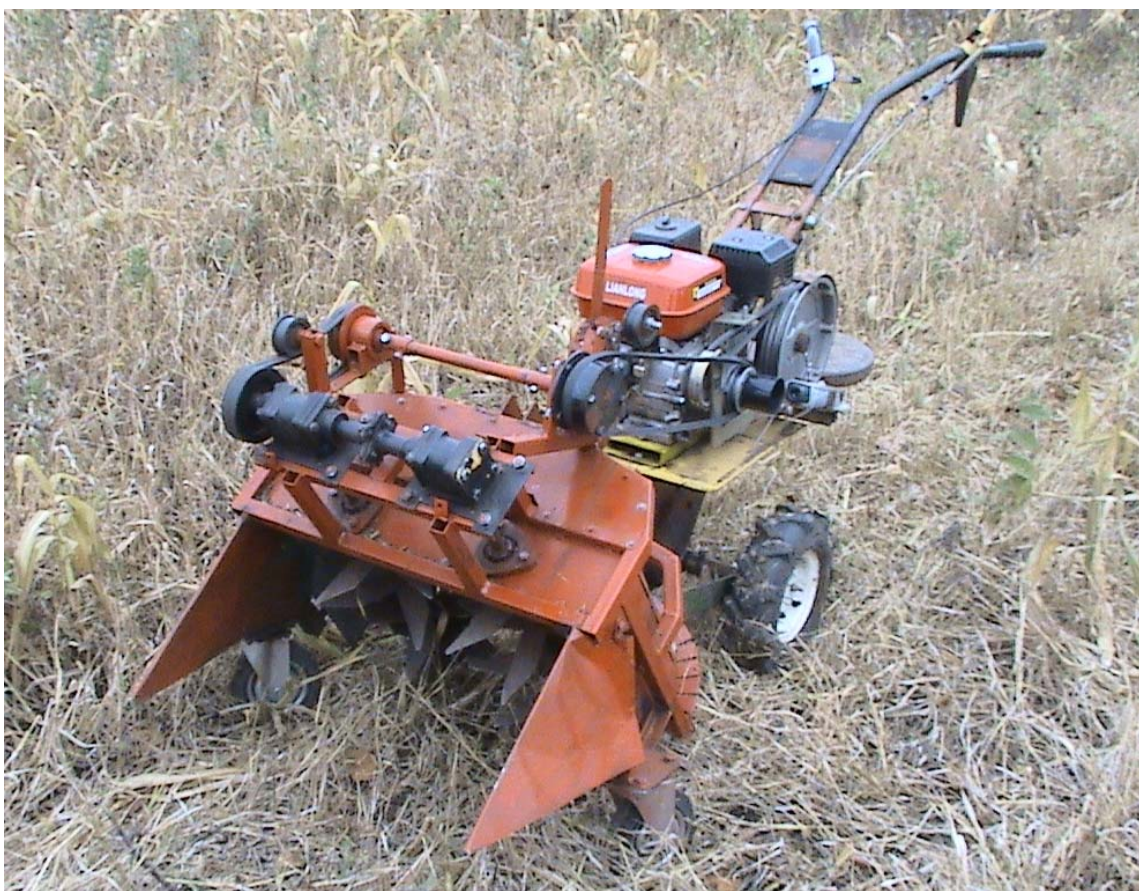
Рис. 2. Экспериментальный образец косилки-измельчителя
