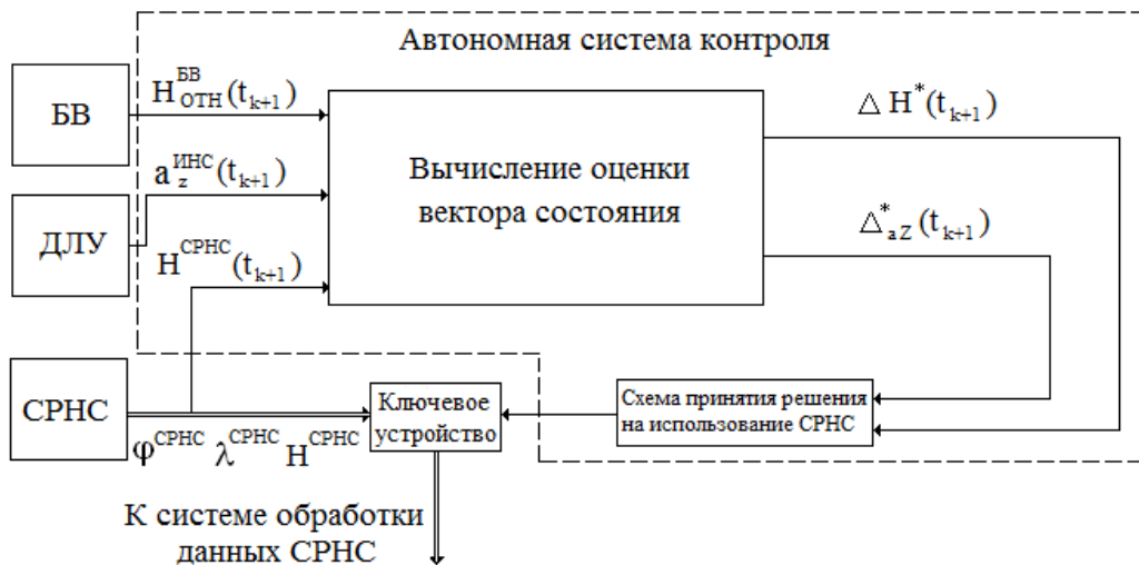
Рис. 1 Структурная схема автономной системы контроля
