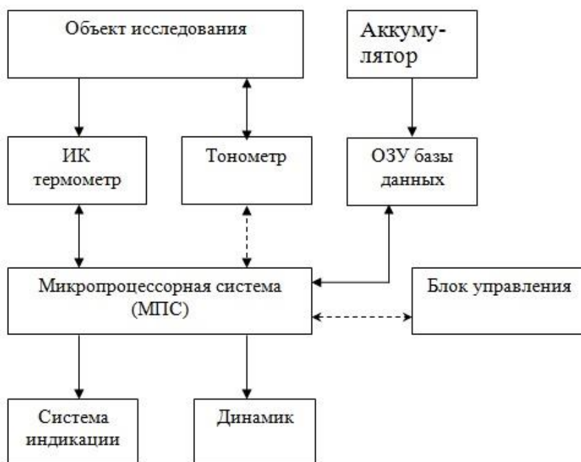
Рис. 1 Блок-схема аппаратной реализации метода определения артериального давления
