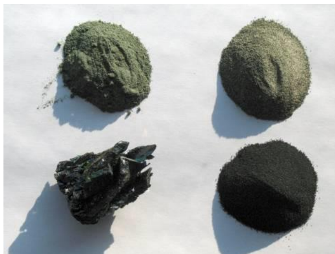
Рис. 5—Образцы карбида кремния и шихты.
