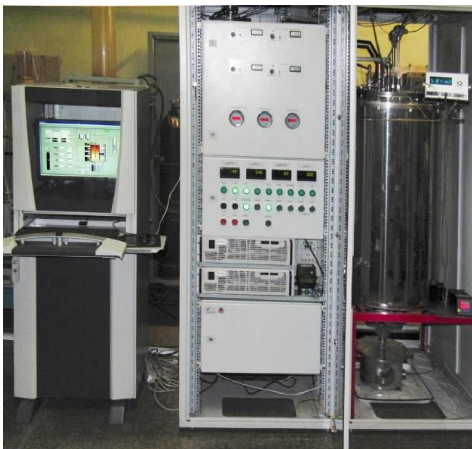
Рис. 2 – Экспериментальная установка с реактором ЭТКС (внутренний диаметр реактора 180 мм, напряжение на электродах ДС0-200 В, электрический ток до 150 А)
