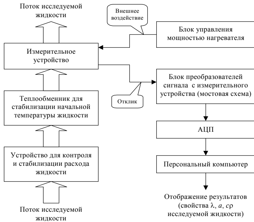
Рис. 1 Структурная схема измерительной установки
