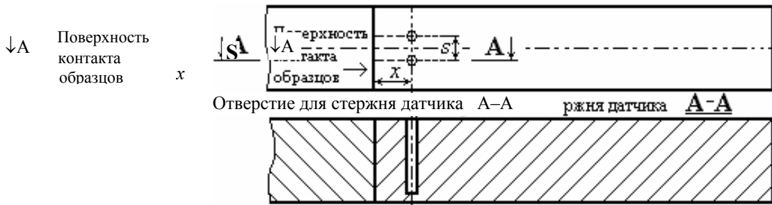
Рис. 2 Установка гальванопары в образце № 2 (вид сверху)
