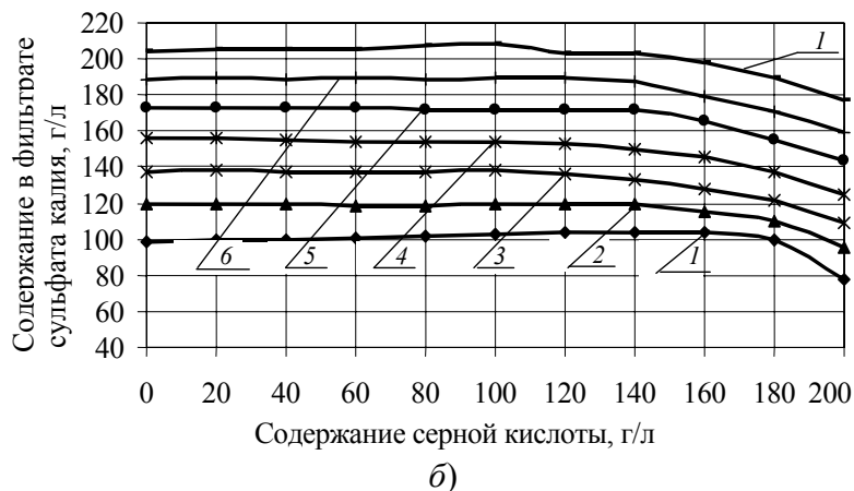
Рис. 1 Влияние содержания серной кислоты на растворимость сульфата натрия (а) и калия (б) при различных температурах в растворе, содержащем 70 г/л гамма-кислоты: 1 – 0 °C; 2 – 10 °C; 3 – 20 °C; 4 – 30 °C; 5 – 40 °C; 6 – 60 °C
