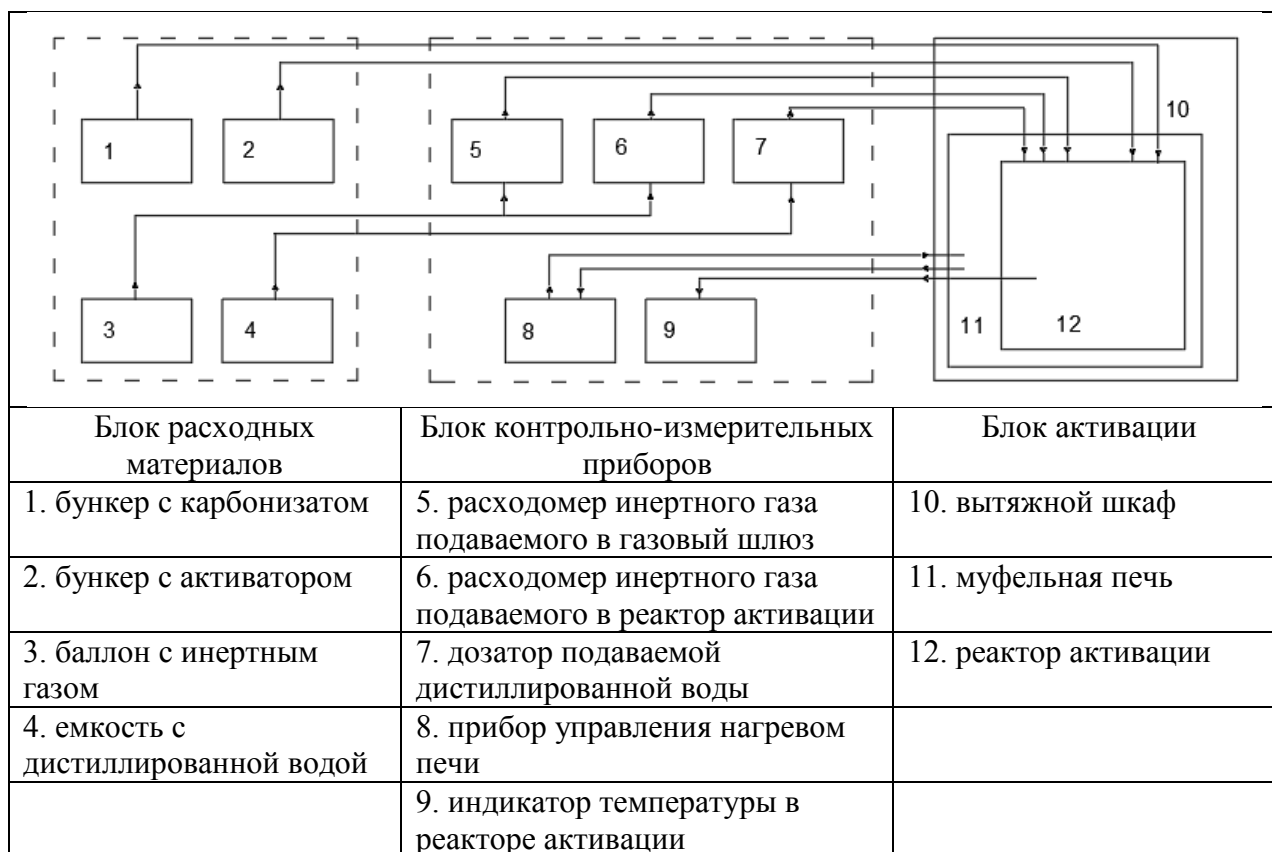
Рисунок 1. Принципиальная схема лабораторной установки для исследования процесса активации.
