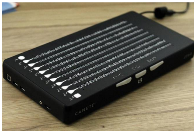
Рис. 2. Электронная книга шрифта Брайля Canute 360
