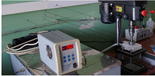
Рис. 1. Опытная установка – четырехшариковая машина трения: 1 – рубашка для теплообмена; 2 – чаша для образцов; 3 – крепление верхнего шарика; 4 – привод; 5 – рычаг для создания нагрузки; 6 – термостат
