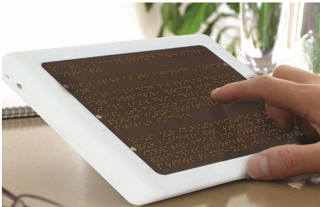
Рис. 1. Прототип системы вывода рельефно-точечного тактильного шрифта на базе электроактивных полимеров
