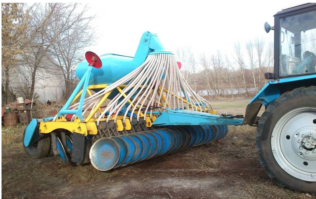
Рис.2. Визуализация физического прототипа комбинированного агрегата для подготовки почвы и посева зерновых культур
