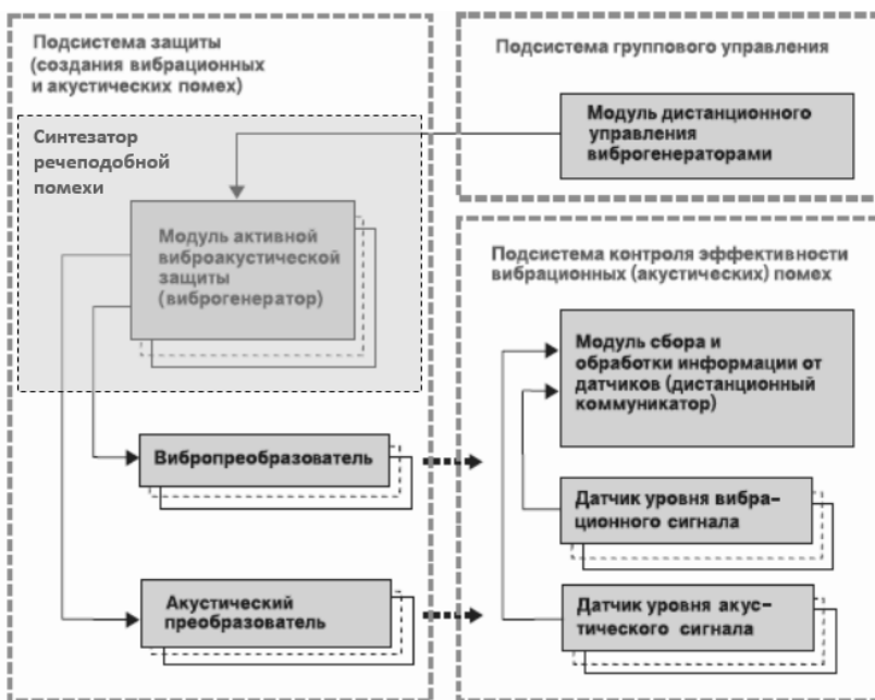
Рис. 17. Общее представление системы активной защиты от несанкционированного прослушивания
