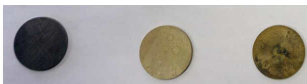
Рис. 3. Гибридные графеновые нанокомпозиты - графеновые нанохлопья (GNF) + наночастицы нитрида бора (в центре) или нитрида алюминия (справа).
