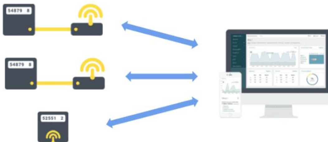
Рис. 1. Принцип работы АСКУЭ
