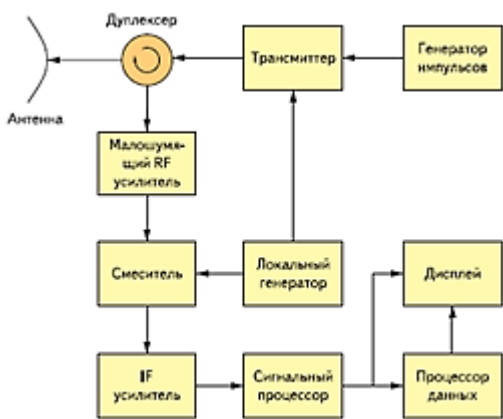
Рис. 1. Структура импульсного радара
