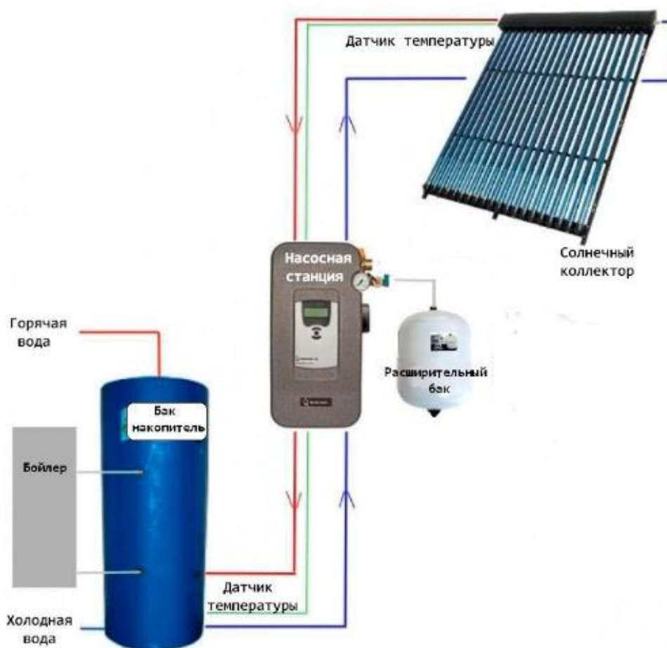
Рис. 1. Схема жидкостной системы солнечного теплоснабжения
