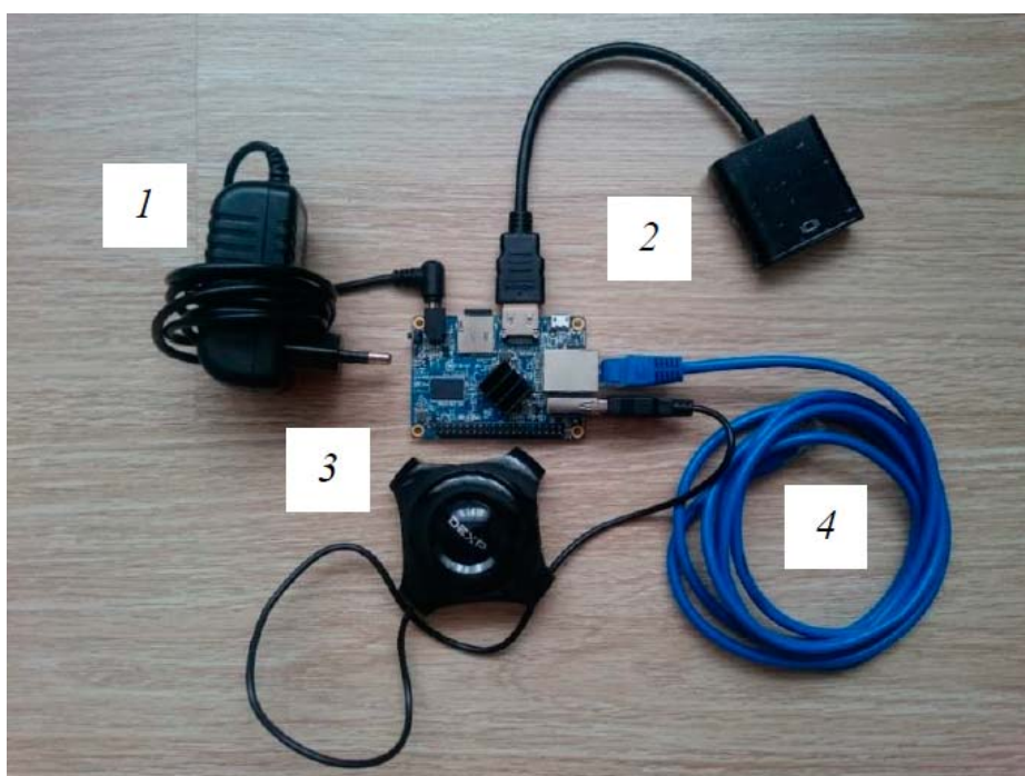
Рис. 2. Orange Pi One с периферией для настройки:
