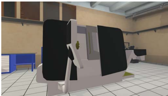
Рис. 7. Токарный обрабатывающий центр CTX 310 ecoline
