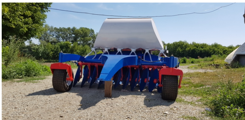
Рис. 1. Изображение опытного образца сеялки для зерновых культур
