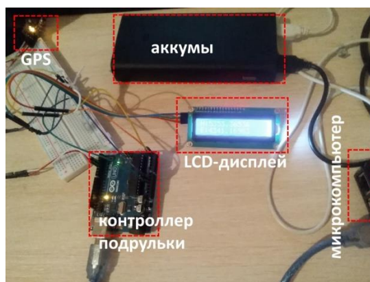
Рис. 5. Подключение устройств подруливающего устройства
