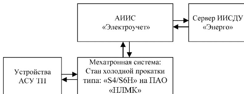
Рис. 1. Структура соединения мехатронной системы и АИИС
