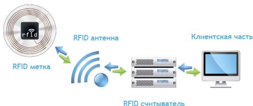
**Рис. 1. Структура системы учета на базе RFID-технологии**
