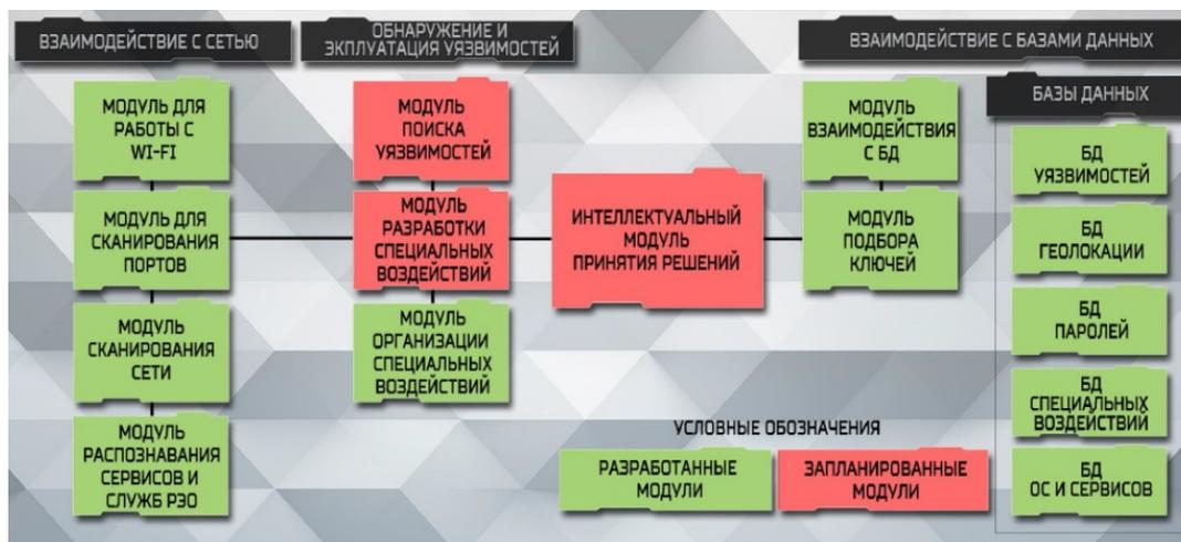
Рис. 1. Модульная архитектура комплекса «Бастион»
