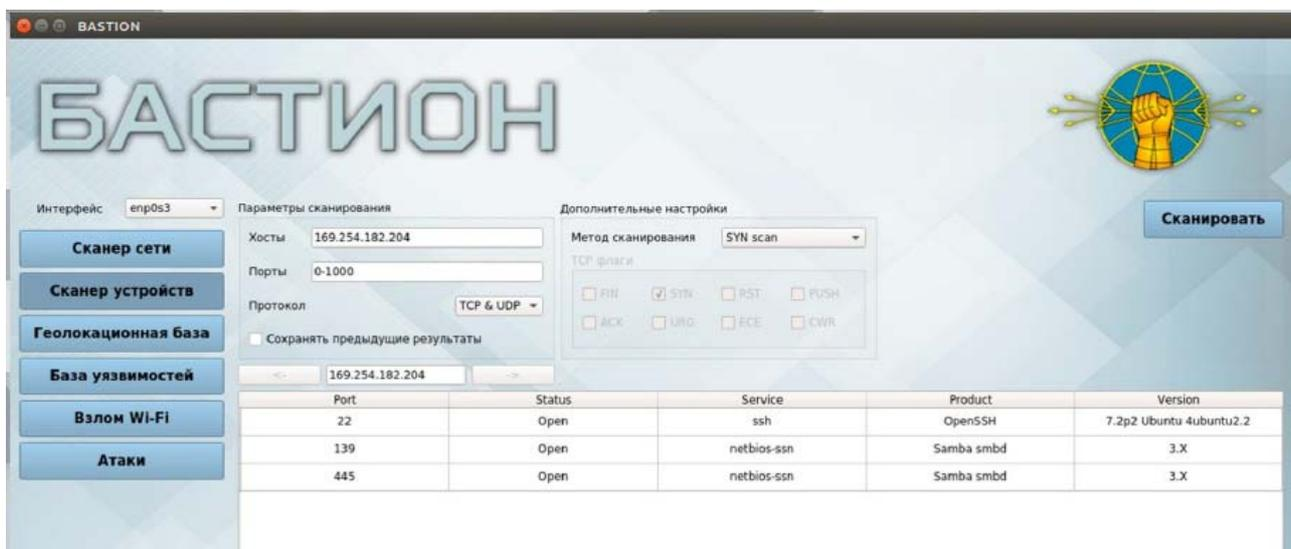
Рис. 2. Результаты работы модуля сканирования устройств комплекса «Бастсион»
