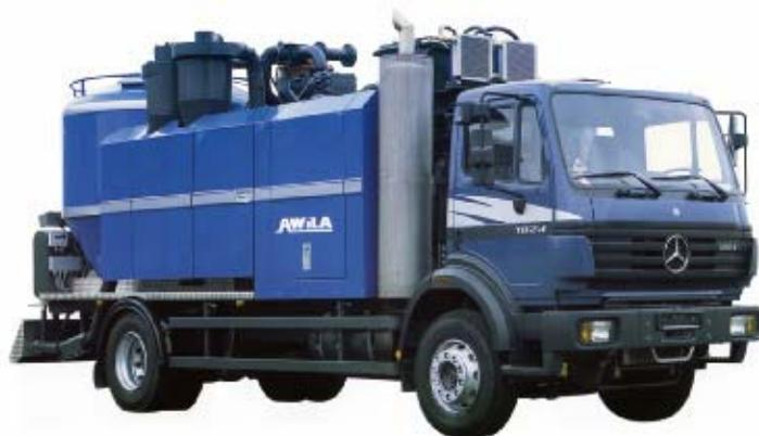
**Рис. 10. Самоходная передвижная дробильно-смесительная установка фирмы Awila**
