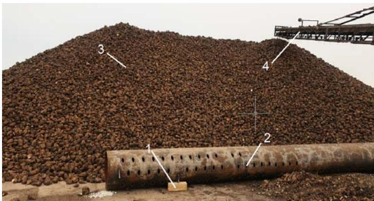
**Рис. 2. Воздуховод равномерной подачи воздуха в насыпь сырья:**
