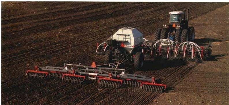
Рис. 4. Сеялка-культиватор Flexi Coil
