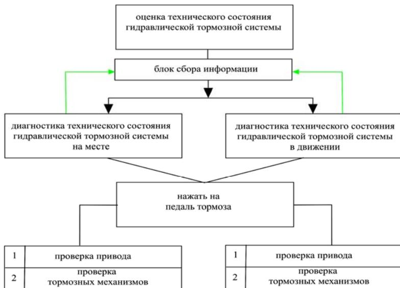
**Рис. 2. Алгоритм методики оценки технического состояния гидравлической тормозной системы**
