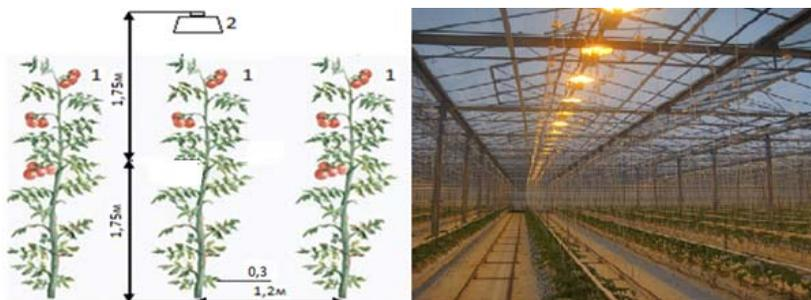
**Рис. 2. Расположение светильников с лампами ДНаТ в светокультуре томата:**
