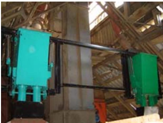
**Рис. 1. Авторегулируемые делители потока зерна с пружинной грузовоспринимающей системой (Патент РФ № 2341954 [1])**
