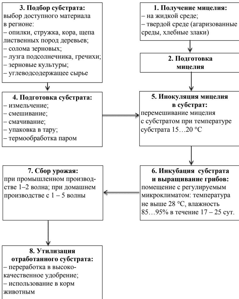
**Рис. 1. Схема технологического процесса производства грибов**
