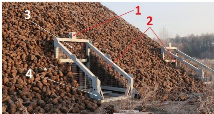
**Рис. 3. Фотография установленной рамы вентиляционного агрегата:**
