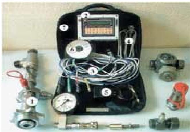
**Рис. 1. Гидротестер ГТП-4,6 М:**
