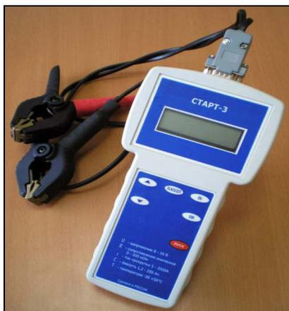
**Рис. 4. Прибор контроля состояния аккумуляторных батарей «СТАРТ-3»**
