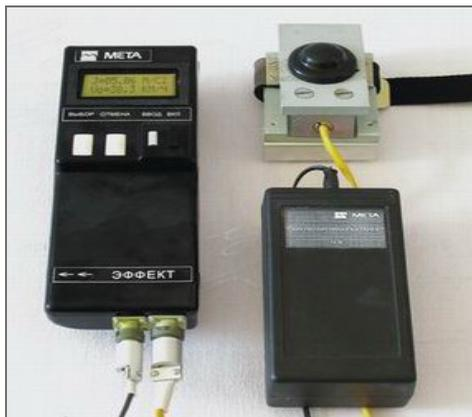
**Рис. 3. Измеритель эффективности тормозных систем автомобилей «ЭФФЕКТ-02»**
