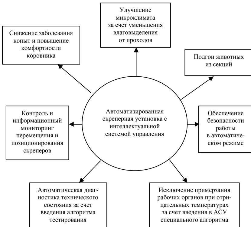
**Рис. 1. Основные задачи интеллектуальной системы управления режимом работы автоматизированной скреперной установки**
