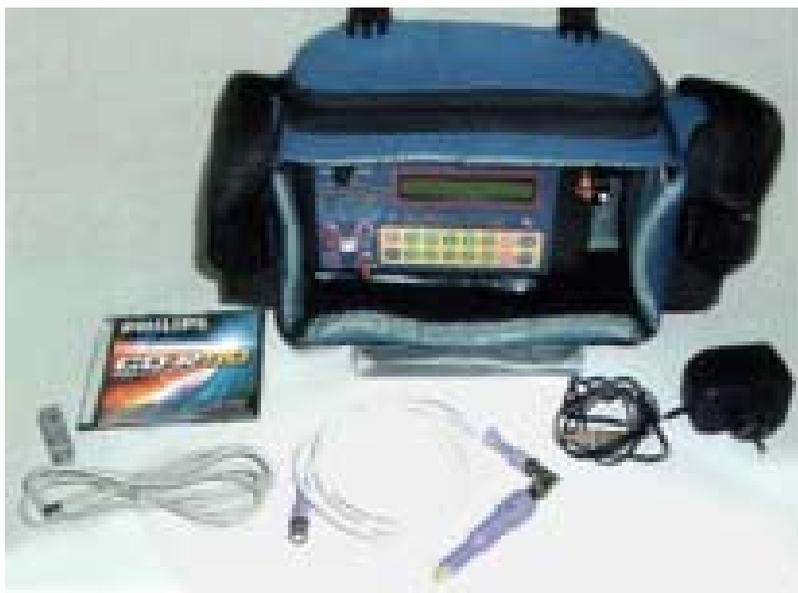
**Рис. 2. Ультразвуковой течеискатель ИВУ-001/5**
