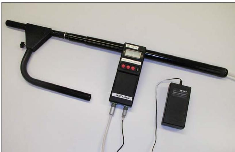
Рис. 1. Измеритель дымности отработавших газов МЕТА-01МП 0.1
