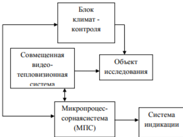
Рис. 1. Блок-схема аппаратной реализации метода
