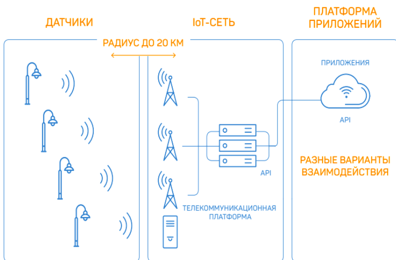
Рис. 2. Структурная схема системы умного уличного освещения на технологии LPWAN
