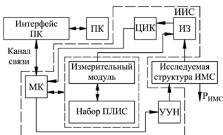
Рис. 1. Структурная схема ИИС для контроля параметров ИМС
