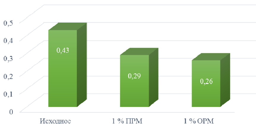
Рис. 4. Изменение смазывающих свойств дизельного топлива после добавления 1% полимеризованного и оксидированного рыжикового масла (20 °С)
