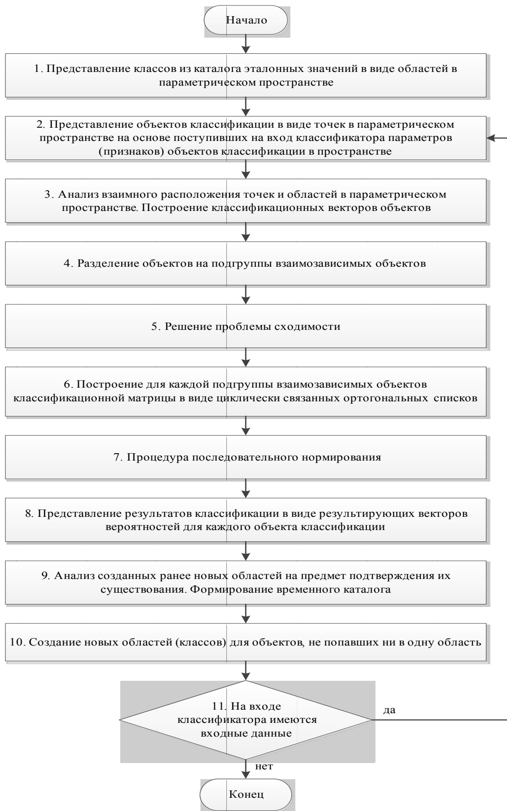
Рис. 2. Блок-схема комбинированной методики классификации авиационных и космических радиотехнических объектов
