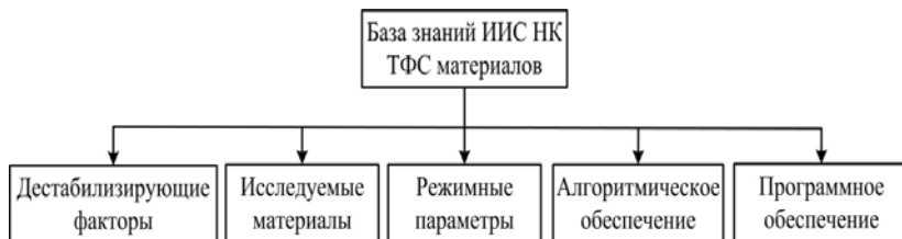
Рис. 3.3. Структурная схема фреймовой модели представления базы знаний ИИС ТФС теплоизоляционных материалов
