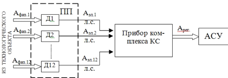
Рис. 1.3. Структурная схема системы контроля на основе ГСП
