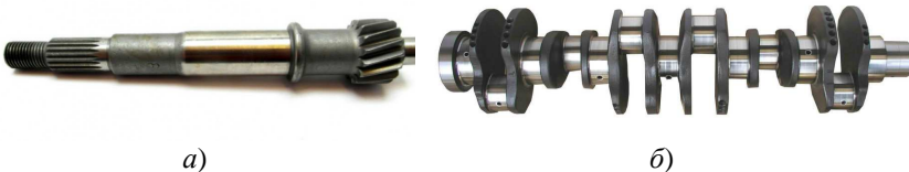
Рис. 1.1. Валы по форме геометрической оси: а – прямой; б – коленчатый
