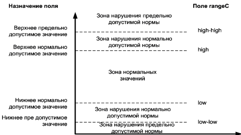
Рис. 4.6. Применение параметра rangeC для целей контроля ПКЭ
