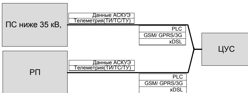
Рис. 5.4. Логическая схема организации связи в МОЭСК
