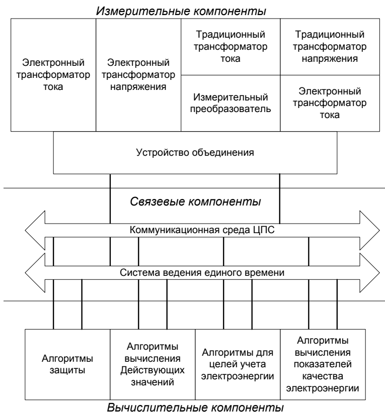
Рис. 4.11. Структура измерительной системы (ИС) ЦПС
