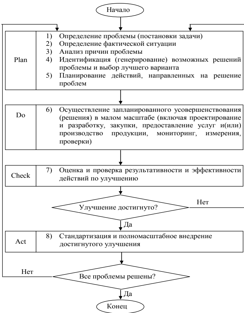
Рис. 2.9. Методология решения проблем и ее связь с циклом улучшения PDCA Деминга
